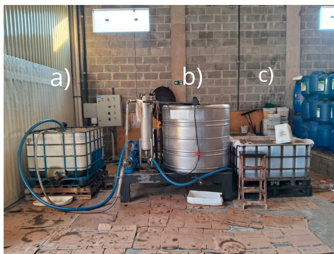
Figura 3 – Etapas do tratamento do óleo de cozinha usado na CooperGore.
