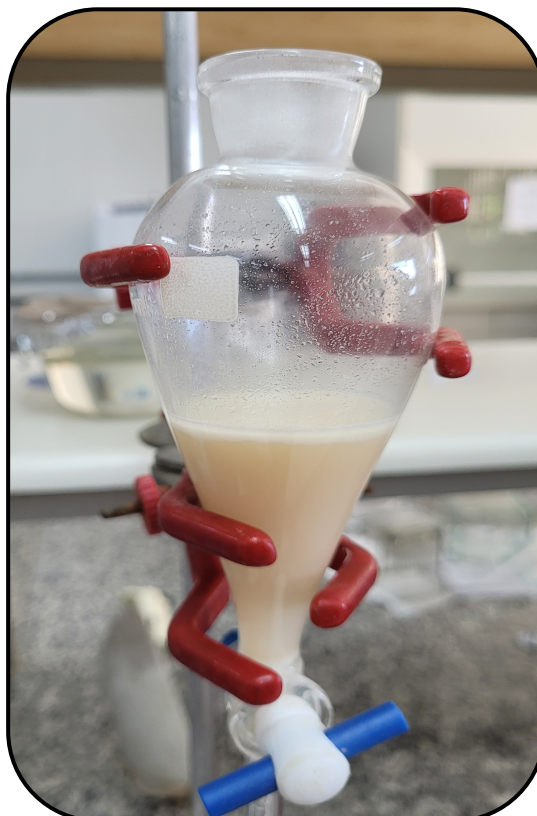
Figura 13 – Separação dos AGL sintetizados por hidrólise
