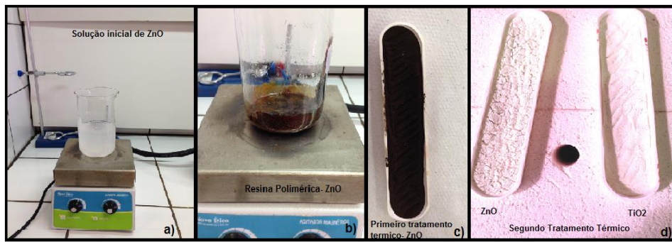
Figura 21 - Síntese do ZnO e seus tratamentos térmicos: a) Solução inicial b) Resina Polimérica c) Primeiro tratamento térmico d) Segundo tratamento térmico.
