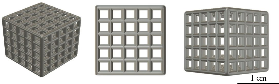
Figura 23 – Vistas isométrica, superior e lateral do modelo desenvolvido com arestas para garantir suporte mecânico ao produto desenvolvido
