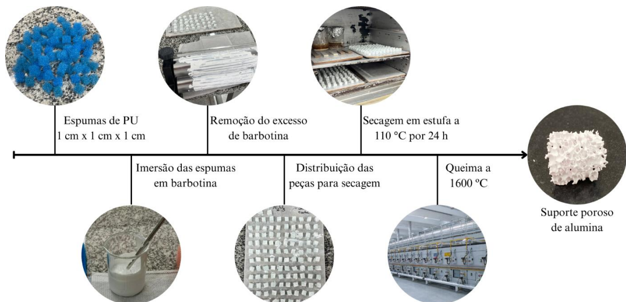
Figura 4 – Detalhamento das etapas propostas para uso da técnica de réplica na produção de cerâmicas porosas
