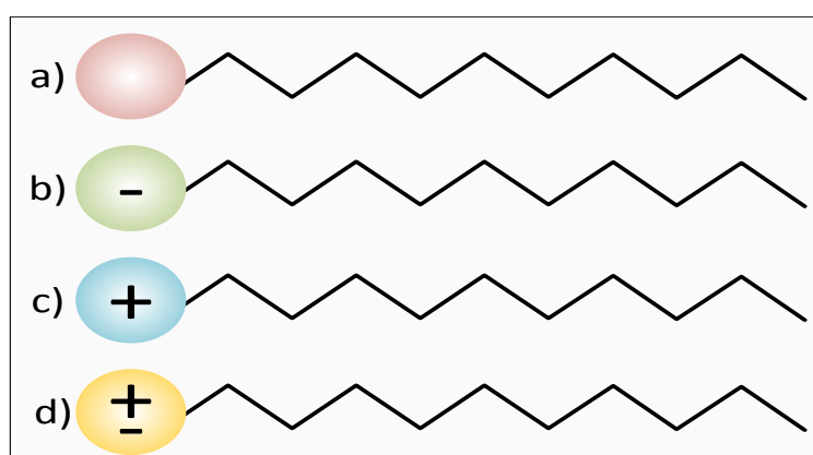
Figura 2 - Classificação dos surfactantes de acordo com a cabeça polar: (a) não-iônico, (b) aniônico, (c) catiônico, (anfótero).
