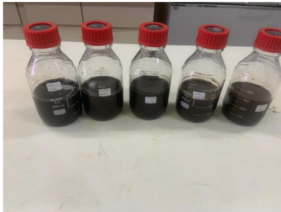
Figura 14 - Reatores metanogênicos, sendo os dois primeiros bióticos, seguidos do controle e abiótico.
