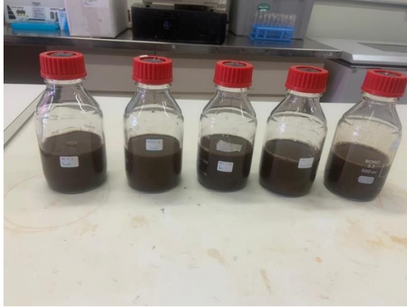
Figura 13 - reatores desnitrificantes, sendo os dois primeiros bióticos, seguidos do controle e abiótico.
