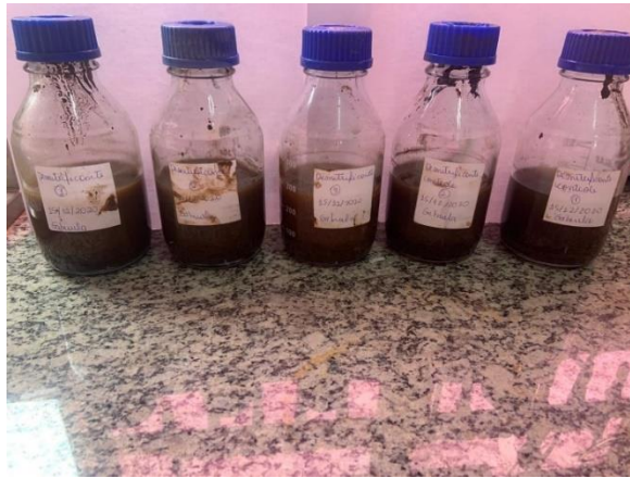
Figura 9 - Reatores de enriquecimento desnitrificantes, sendo os três primeiros com 2,4-D e os dois últimos sem
