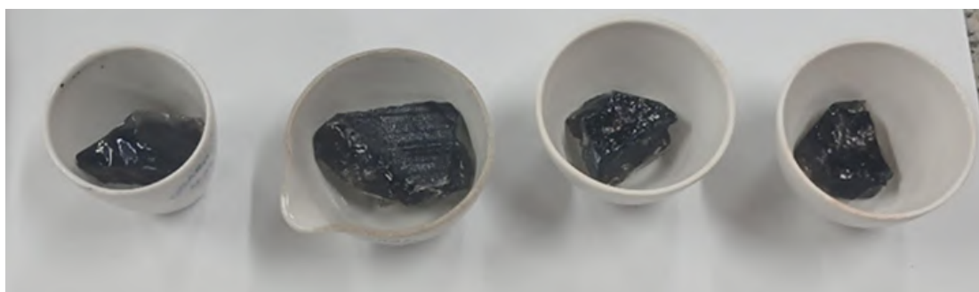
Figura 59 - Sexto teste da segunda etapa: amostras antes do tratamento térmico inseridas no cadinho de porcelana
