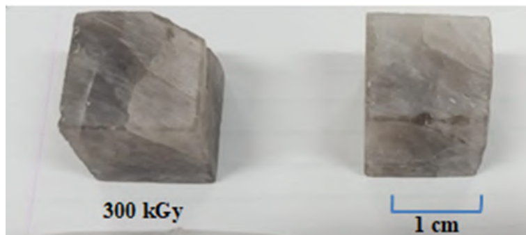
Figura 34 - Amostras irradiadas a 300 kGy, a temperatura de 350°C a 12 minutos (esquerda) e a 370°C a 10 minutos (direita)
