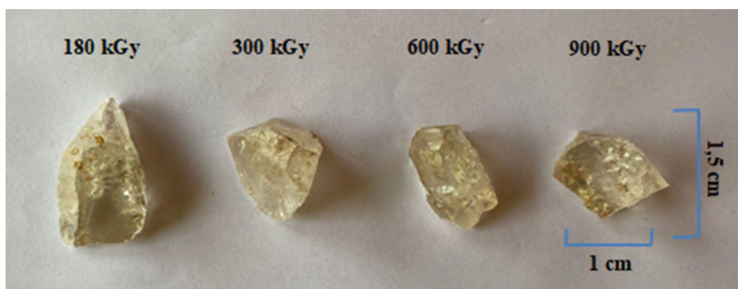
Figura 61 - Sétimo teste da segunda etapa: Resultado das amostras submetidas a 410°C por 12 minutos
