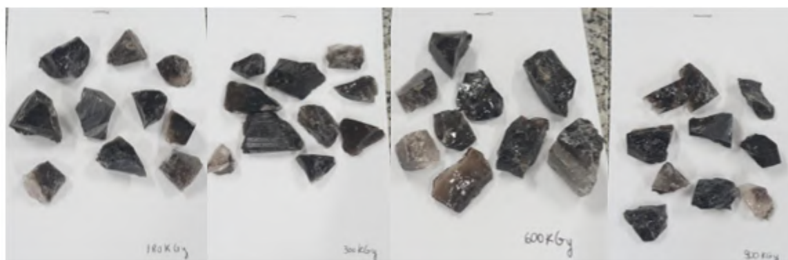
Figura 42 - Amostras irradiadas a 180, 300, 600 e 900 kGy para utilizadas na segunda etapa de testes do experimento
