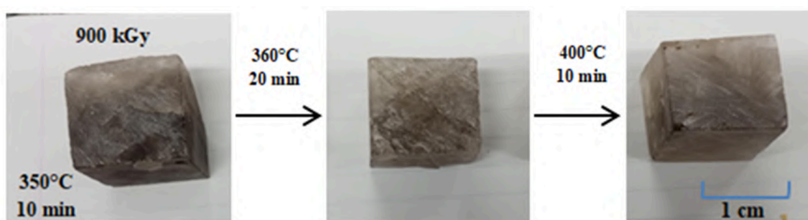
Figura 40 - Resultado das amostras irradiadas a 900 kGy a temperatura de 350°C por 10 minutos, 360°C por 20 minutos e 380°C por 12 minutos da esquerda para direita.
