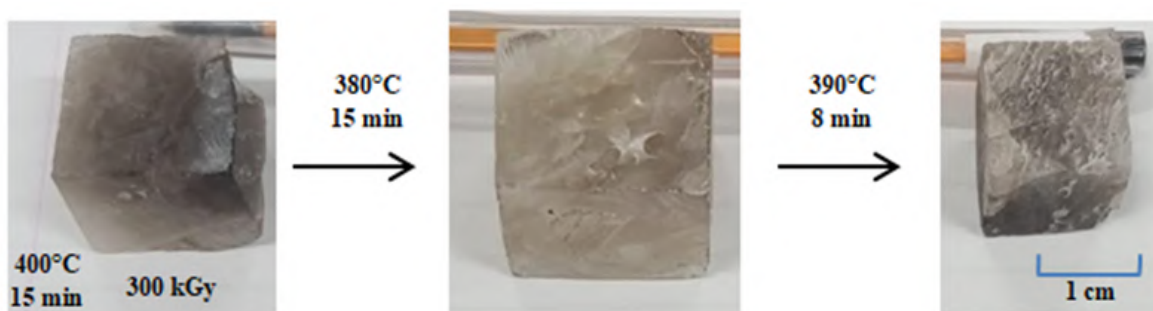
Figura 35 - Amostras irradiadas a 300 kGy, a temperatura de 400°C com exposição do tempo de 15 minutos, 380°C a 15 minutos e a 390°C por 8 minutos, nessa ordem
