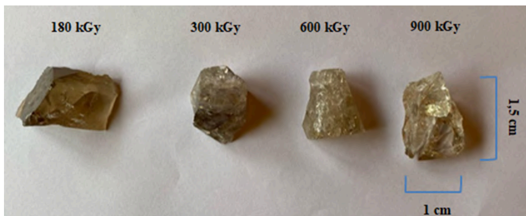
Figura 62 - Oitavo teste da segunda etapa: Resultado das amostras submetidas a 390°C por 15 minutos
