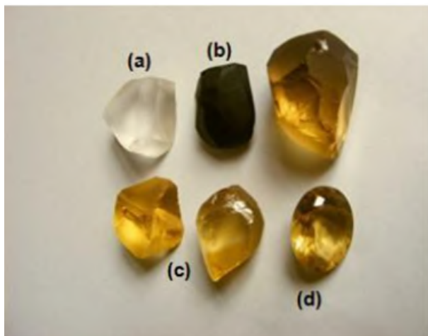
Figura 8 - Quartzo honey incolor (a), depois de irradiado (b), irradiado e tratados termicamente (c) e lapidado (d).
