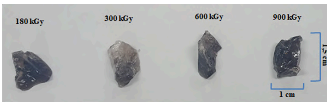
Figura 50 - Amostras submetidas a 350°C por 10 minutos
