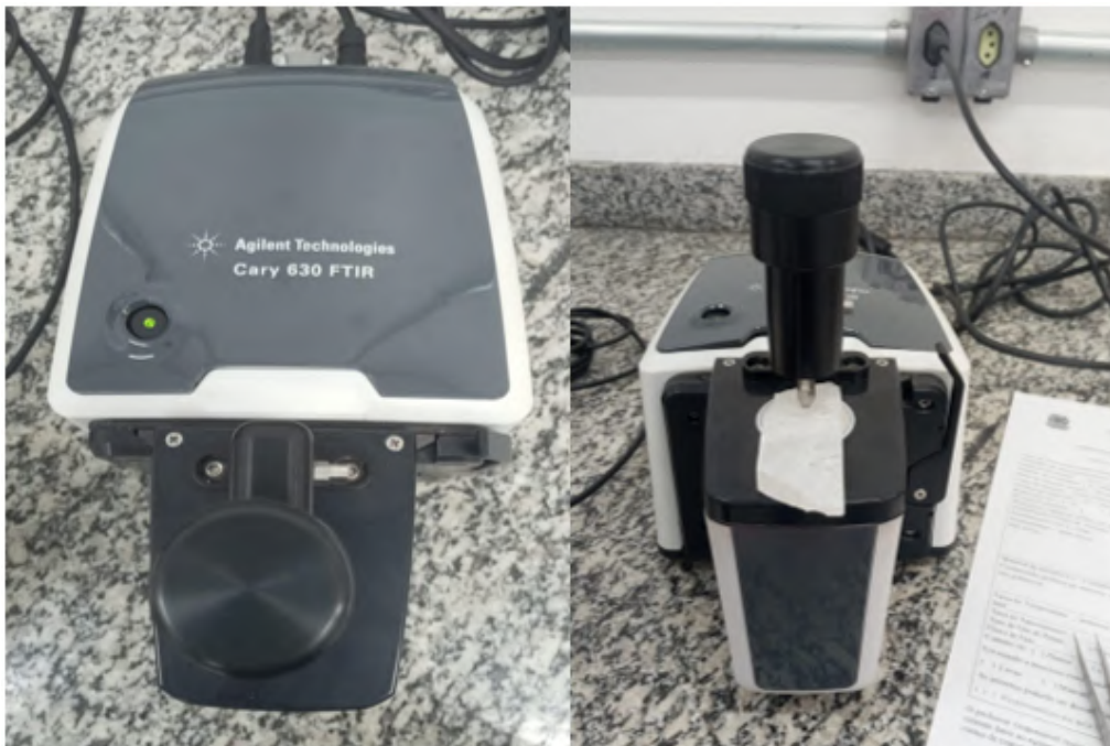
Figura 18 - Espectrômetro de bancada do tipo FTIR Cary 360 a esquerda e o equipamento sendo testado com uma peça bruta da pesquisa (direita)
