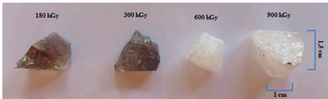
Figura 57 - Quinto ensaio da segunda etapa: amostras submetidas a 400°C por 12 minutos
