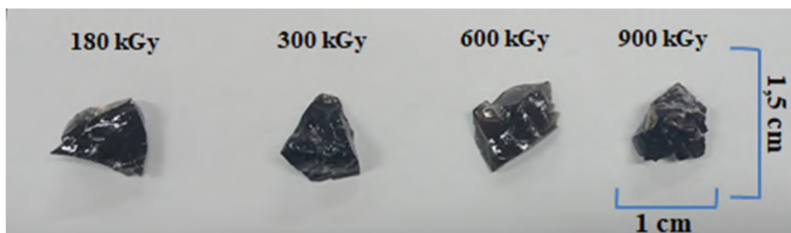
Figura 54 - Quarto teste da segunda etapa: amostras antes de serem aquecidas.
