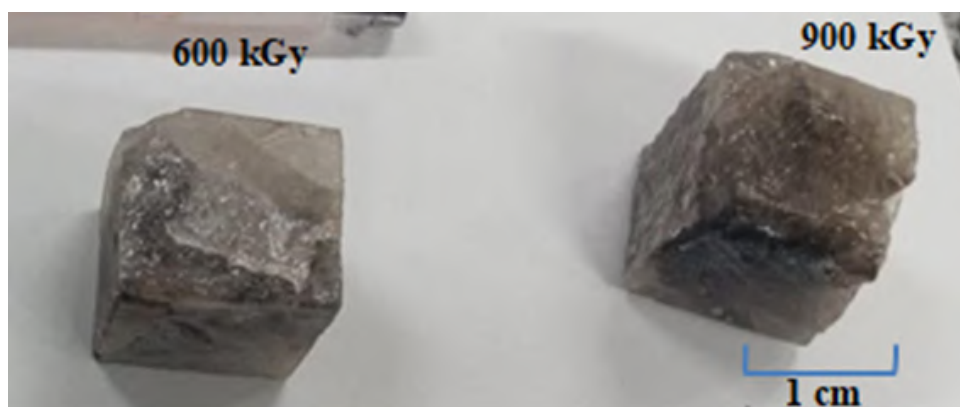
Figura 29 - Amostras após tratamento térmico de 300°C por 25 minutos de 600 e 900 kGy.
