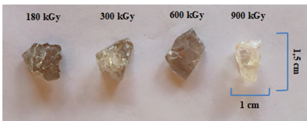
Figura 55 - Quarto teste da segunda etapa: Amostras aquecidas a 410°C por 15 minutos
