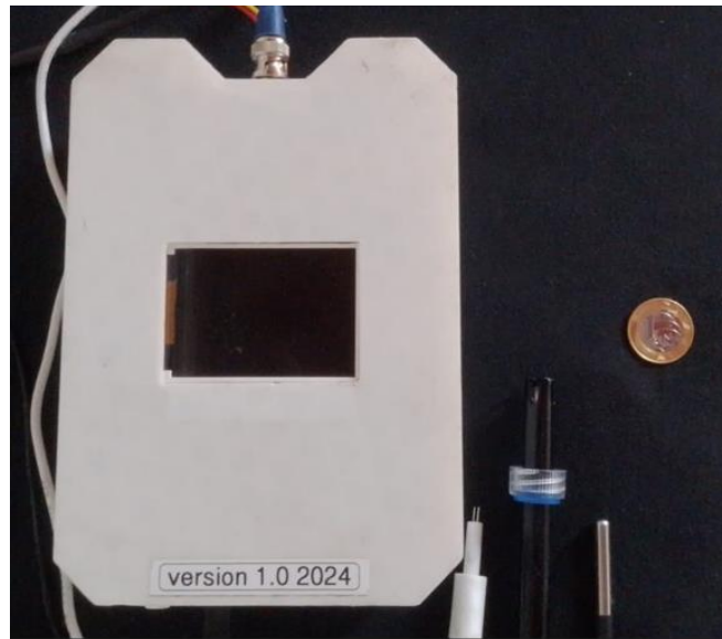
Figura 14 - Gabinete impresso para aquisição dos componentes do sistema automatizado
