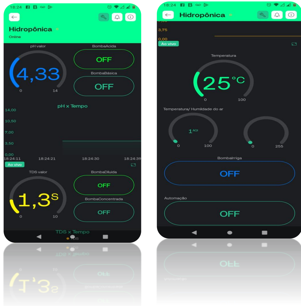
Figura 20 - Dashboard Criado para monitorar a e aplicar comandos pela plataforma blynk
