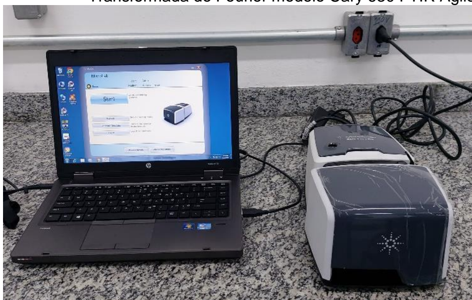
Figura 34 - Equipamento de espectroscopia na região do infravermelho por Transformada de Fourier modelo Cary 630 FTIR Agilent
