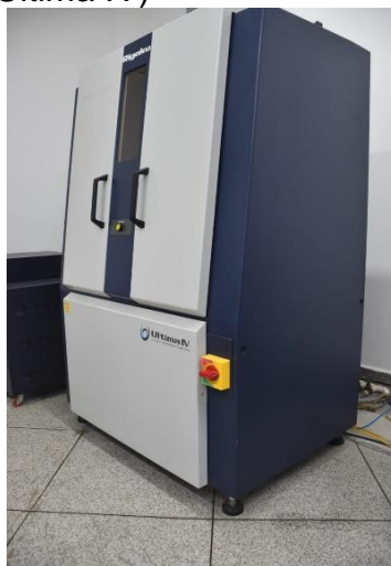
Figura 31 - Equipamento de análise de Difração de Raios-X (Rigaku Ultima IV)
