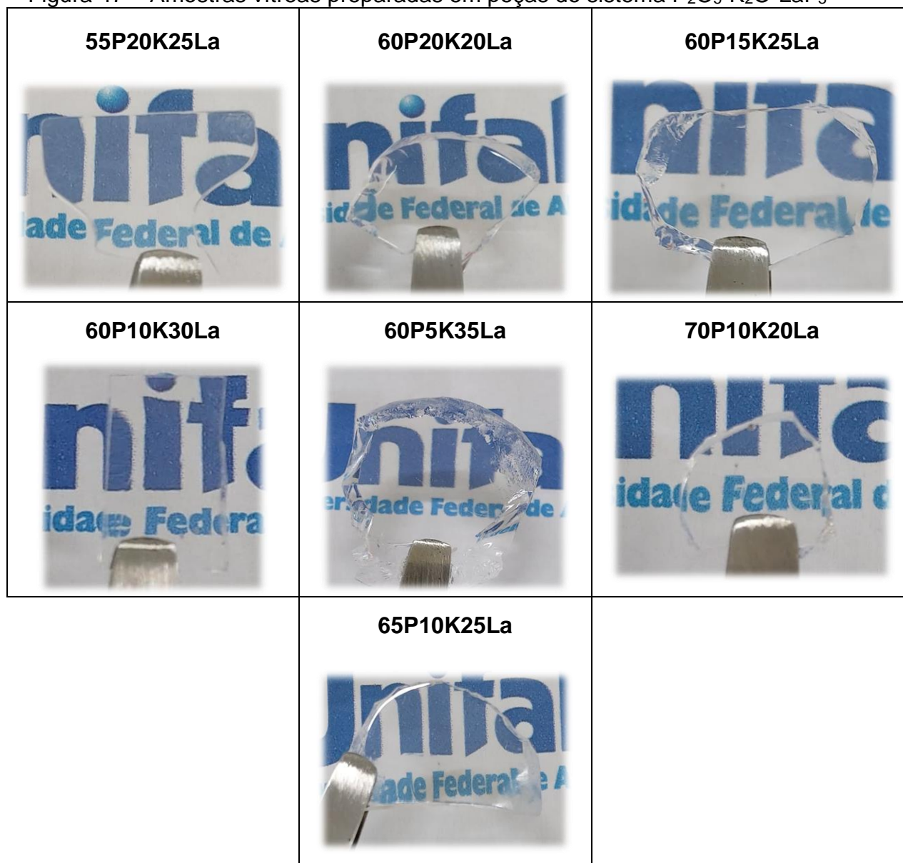
Figura 47 – Amostras vítreas preparadas em peças do sistema P_2O_5 - K_2O - LaF_3
