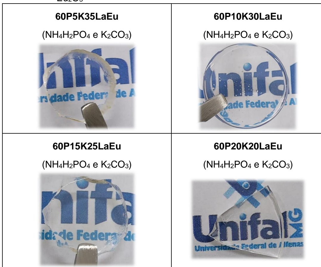
Figura 61 - Amostras vítreas preparadas em peças do sistema P_2O_5 - K_2O - LaF_3 - Eu_2O_3
