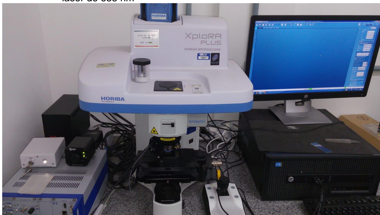
Figura 32 - Equipamento de espectroscopia Raman modelo Horiba Xplora Plus de laser de 638 nm
