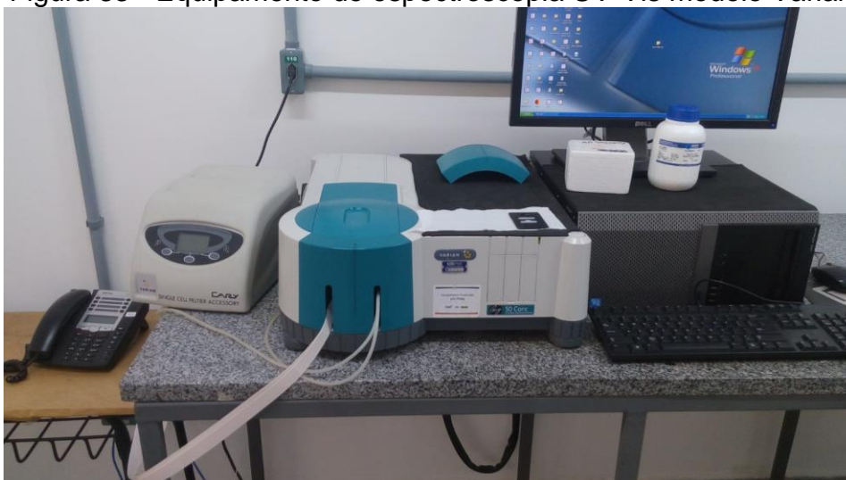
Figura 33 - Equipamento de espectroscopia UV-Vis modelo Varian Cary 50
