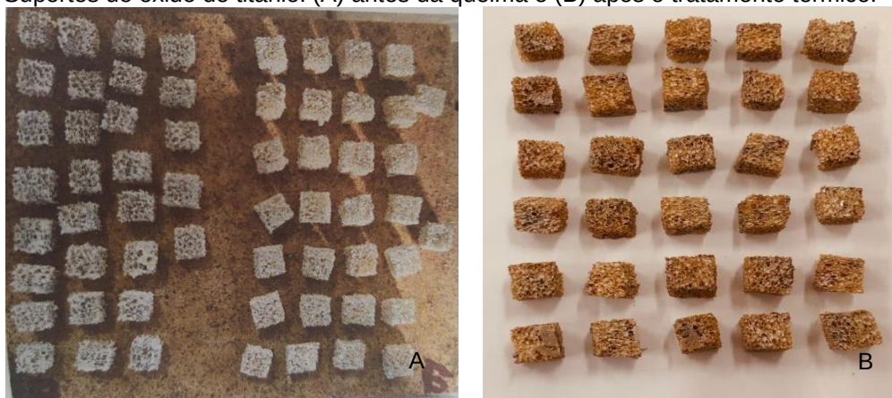
Figura 3 - Suportes de óxido de titânio: (A) antes da queima e (B) após o tratamento térmico.
