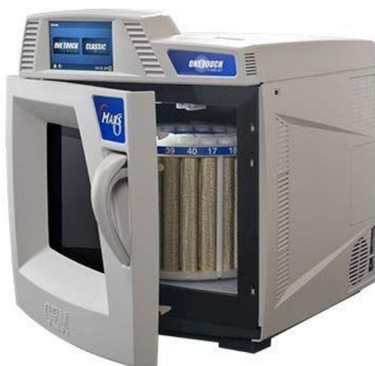
Figura 11 - Equipamento micro-ondas utilizado na síntese das zeólitas.
