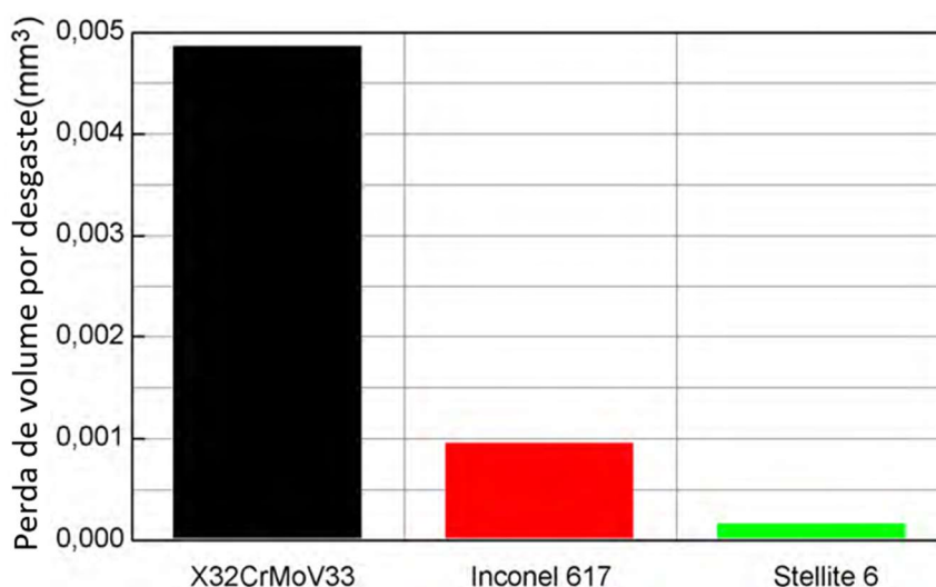
Figura 14 - Perda de volume da ligas X32CrMoV33 aço ferramenta, Inconel 617 e Stellite 6 submetidas ao teste de desgaste ball-on-disc sob alta temperatura.
