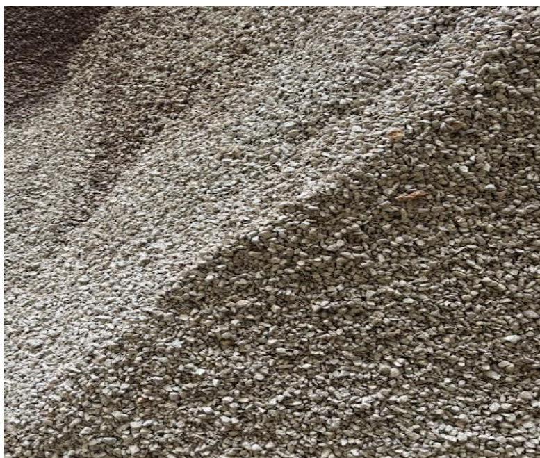
Figura 8 – Granito em pedrisco de granulometria inferior a 4,0 mm recebido do fornecedor da região de Campinas – SP e usado no processo proposto.
