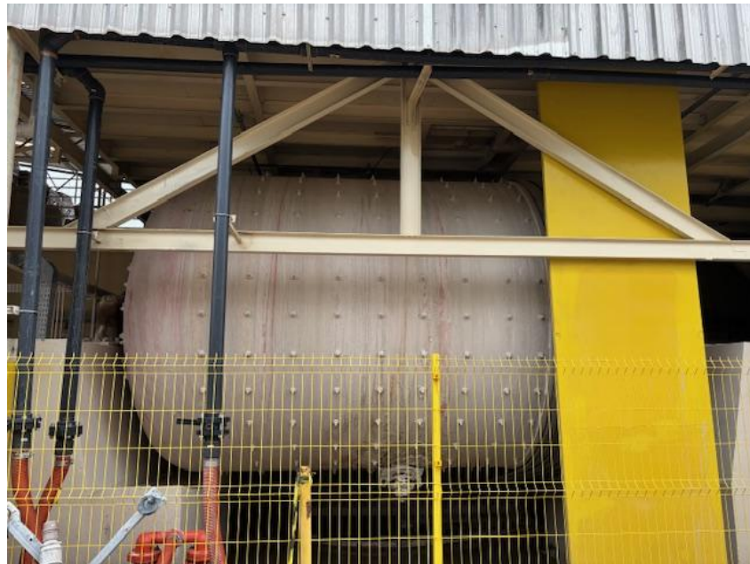
Figura 5 – Moinho do processo atual, com capacidade de 15.000 litros, revestimento interno de borracha.
