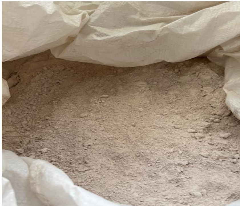
Figura 4 – Granito moído #200 mesh que é alimentado no moinho para homogeneização.
