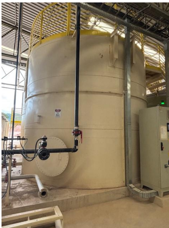
Figura 7 – Tanque para estocagem da barbotina após o descarregamento do moinho no processo atual.
