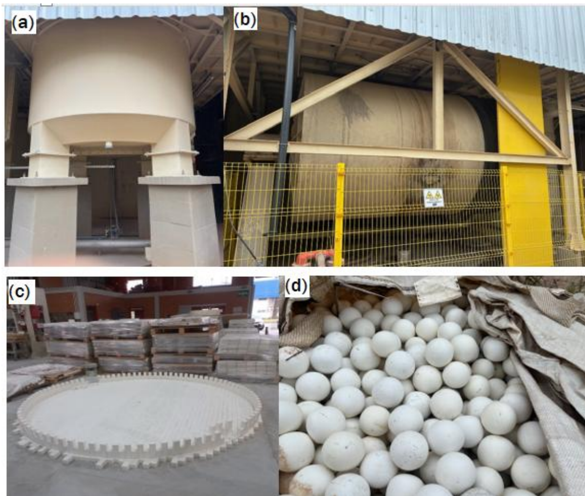
Figura 9 – Equipamentos no novo processo implantado: (a) Blungers para homogeneização do caulim na mistura de barbotina de argilas, filitos e granito, com volume de 18.000 litros; (b) Moinho do processo novo, com capacidade para 15.000 litros de suspensão e revestimento de tijolos de alumina de alta densidade; (c) Parte da cabeceira do revestimento de tijolos de alumina de alta densidade do moinho do processo proposto e (d) Corpos moedores do novo moinho, composto por esferas de alto teor de alumina.
