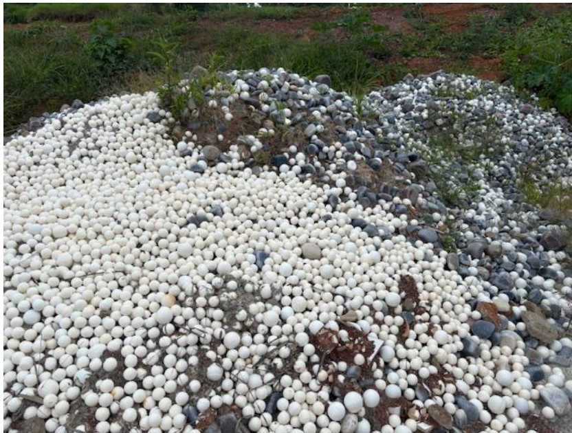
Figura 6 – Corpos moedores do processo atual, com carga mista de esferas de alumina de alta densidade e seixos, sem controle de tamanho.
