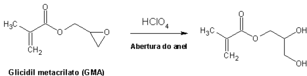
Figura 4 - Reação de abertura do anél epóxido do monômero glicidil metacrilato. Fonte: Do autor.
