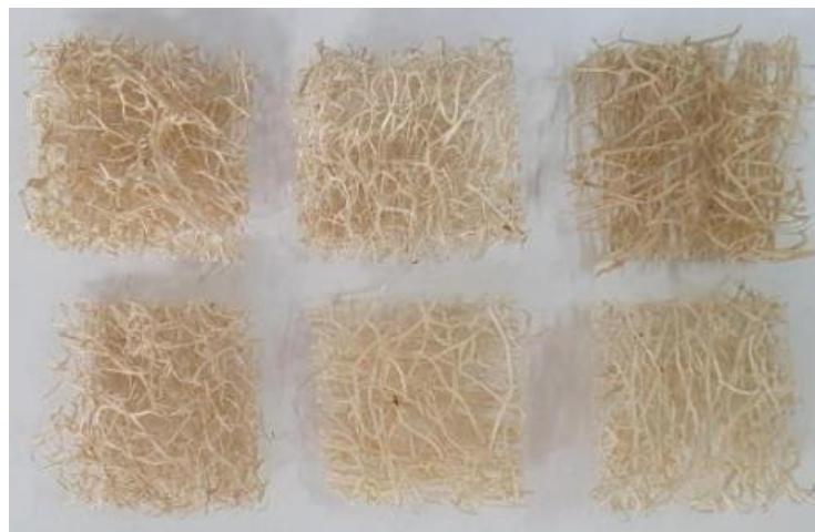
Figura 4- Esponja vegetal em formato de cubos de 1,0 cm de aresta para a imobilização de células biocatalíticas de A. oryzae IPT-301
