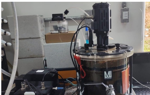
Figura 2 - Reator CSTR de bancada utilizado para pesquisa.
