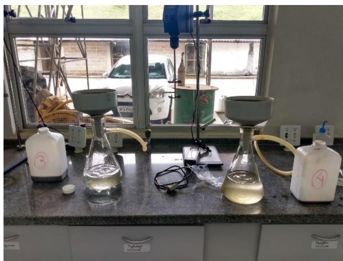
Figura 19 - Primeira filtração para obtenção do extrato lixiviado (filtro de papel)
