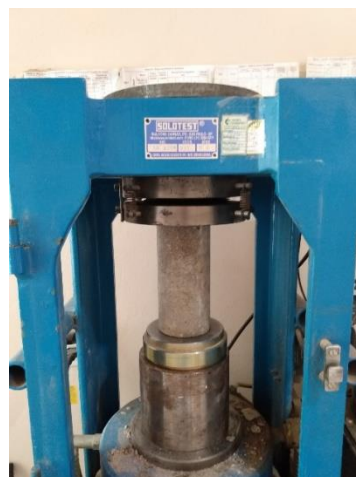
Figura 12 - Realização do ensaio de compressão; a) e b)
