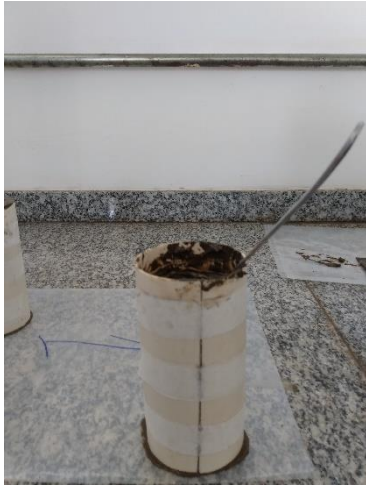
Figura 9 - Preenchimento, adensamento e moldagem dos corpos de prova; a), b) e c)
