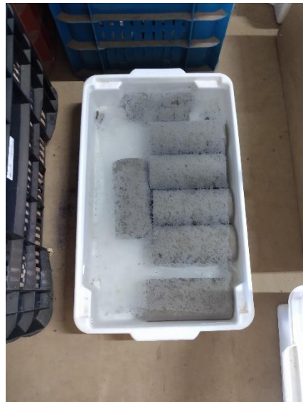
Figura 11 - Corpos de prova submetidos à cura submersa; a) período de cura: 1 dia e b) período de cura: 7 dias
