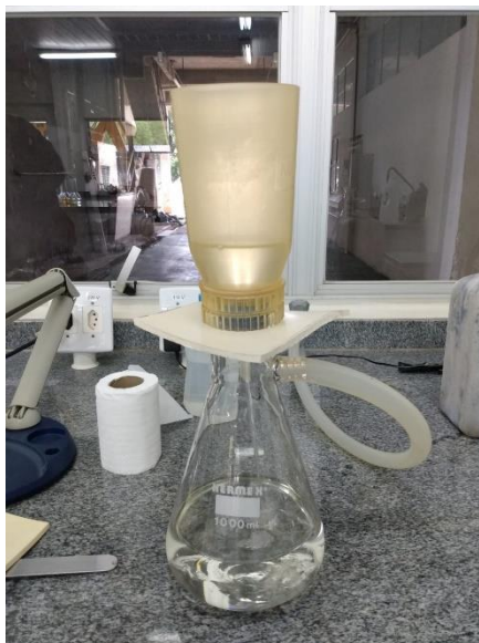
Figura 20 - Segunda filtração para obtenção do extrato lixiviado ( micropore )
