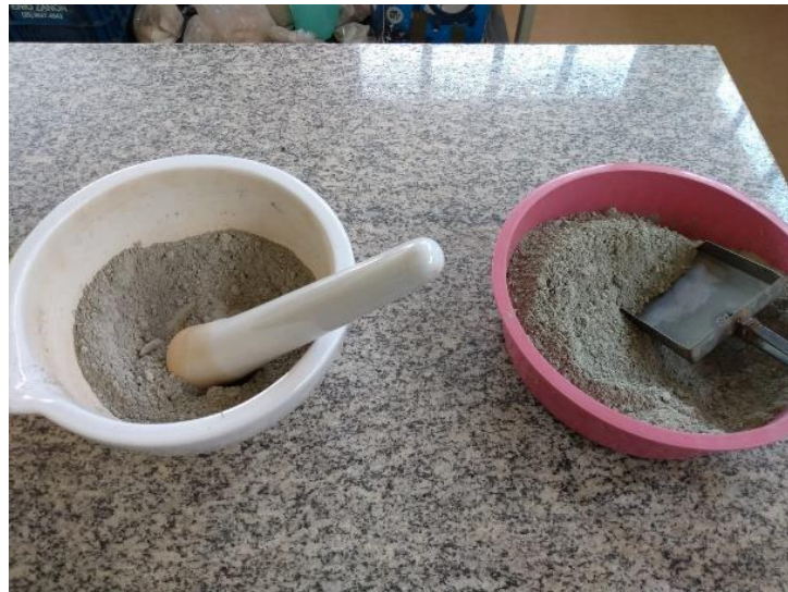
Figura 6 - Eliminação de cimento aglomerado
