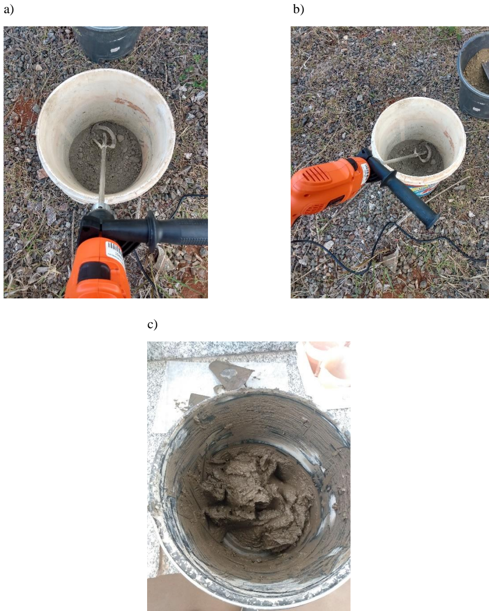
Figura 8 - Sistema para homogeneização dos componentes e preparo das massas; onde a) e b) homogeneização dos materiais particulados; c) massa homogeneizada e preparada para a confecção dos corpos de prova
