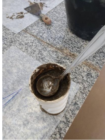
Figura 9 - Preenchimento, adensamento e moldagem dos corpos de prova; a), b) e c)
