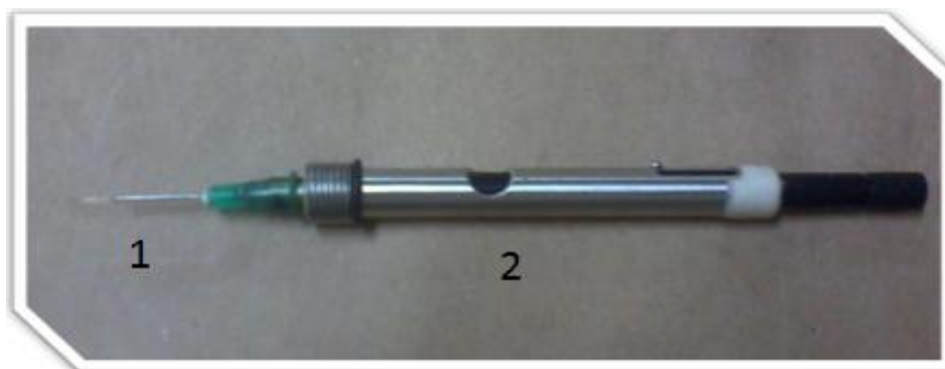
Figura 5 - Fibra de MIP ou NIP (1) acoplado ao holder (2)
