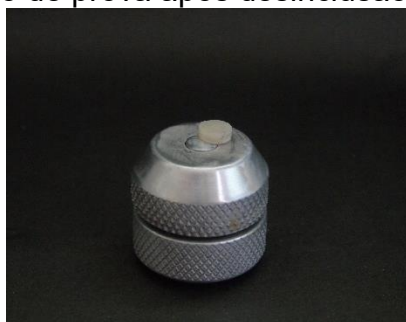
Figura 14 — Corpo de prova após desinclusão da matriz metálica
