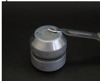
Figura 13 — Remoção dos excessos com lâmina de bisturi #15C
