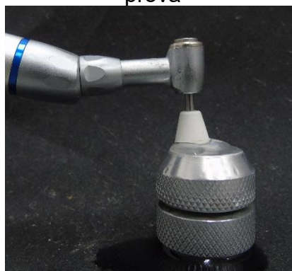
Figura 23 — Demonstração da aplicação da borracha abrasiva fina sobre o corpo de prova
