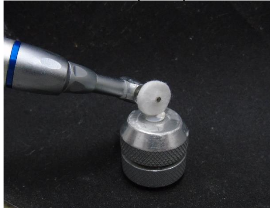
Figura 20 — Demonstração da aplicação do disco de feltro impregnado com pasta sobre o corpo de prova
