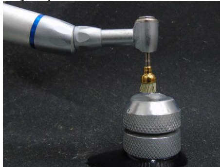
Figura 18 — Aplicação paralela da escova sobre o corpo de prova
