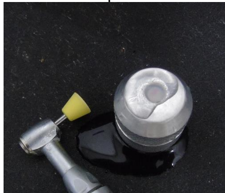
Figura 22 — Demonstração da aplicação da borracha abrasiva média sobre o corpo de prova
