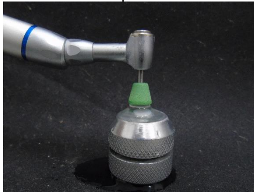
Figura 21 — Demonstração da aplicação da borracha abrasiva grossa sobre o corpo de prova
