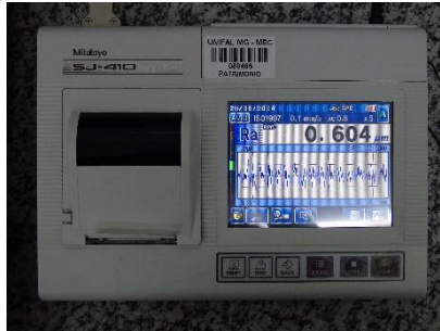
Figura 26 — Tela do Rugosímetro com resultado de Ra e parâmetros aplicados
