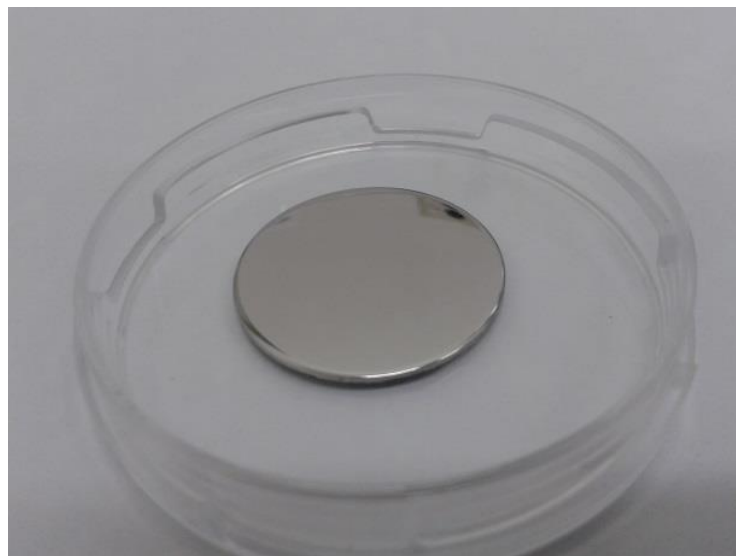
Figura 16 – Disco de aço inoxidável polido com suspensão sílica coloidal. Fonte: Bergamini, G.
