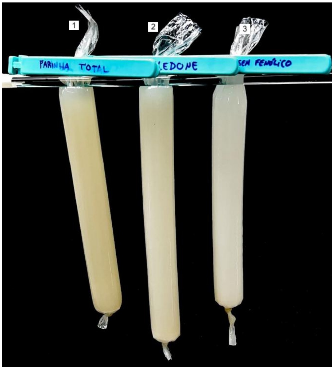
Figura 7. Aparência das membranas de diálise contendo os sobrenadantes das extrações de globulinas, pós-diálise, conforme descrito em Material e Métodos (item 3.2.2): (1) extração da globulina G1, obtida a partir de grãos íntegros com casca; (2) extração da globulina G2, isolada de grãos descascados (cotilédones); (3) extração da globulina (G3) isolada de cotilédones após a extração de compostos fenólicos com acetona 70% (v/v).
