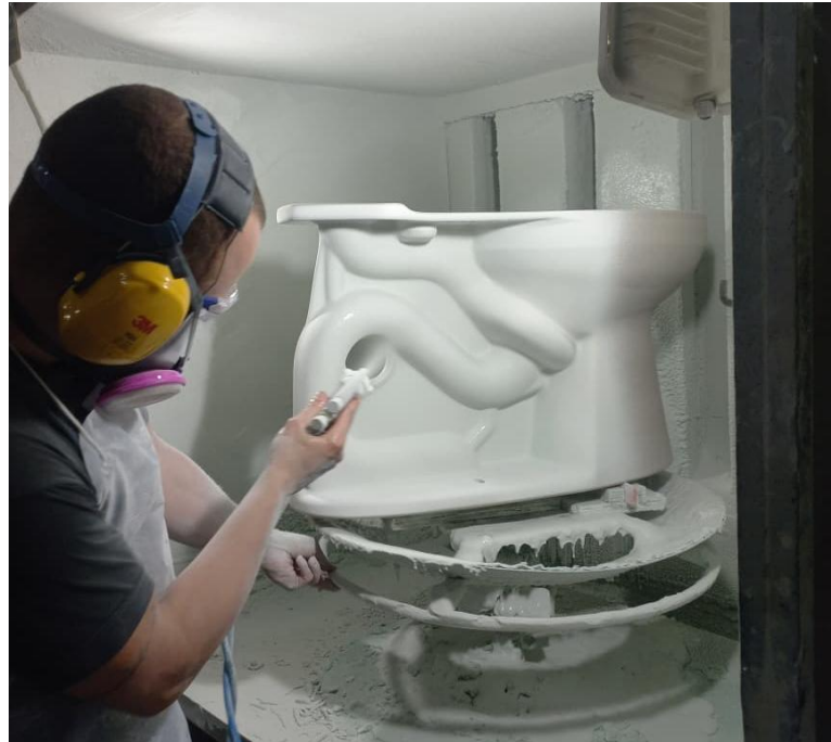
Figura 3 - Processo de esmaltação manual de bacia sanitária
