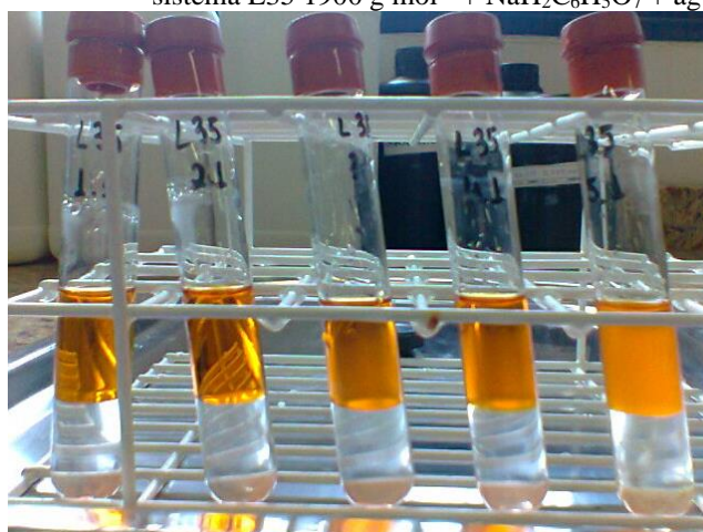
Figura 2.8 - Partição do extrato de urucum utilizando CTAB a 8,0 \times 10^{-4} \text{ mol L}^{-1} no sistema L35 1900 \text{ g mol}^{-1} + \text{NaH}_2\text{C}_6\text{H}_5\text{O}_7 + água, a 298,15 K.
