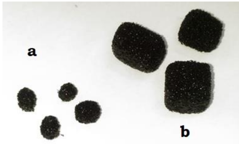
Figura 6 – Espumas de poliuretano após a operação dos reatores (onde a corresponde as espumas dos reatores industriais e b dos domésticos)
