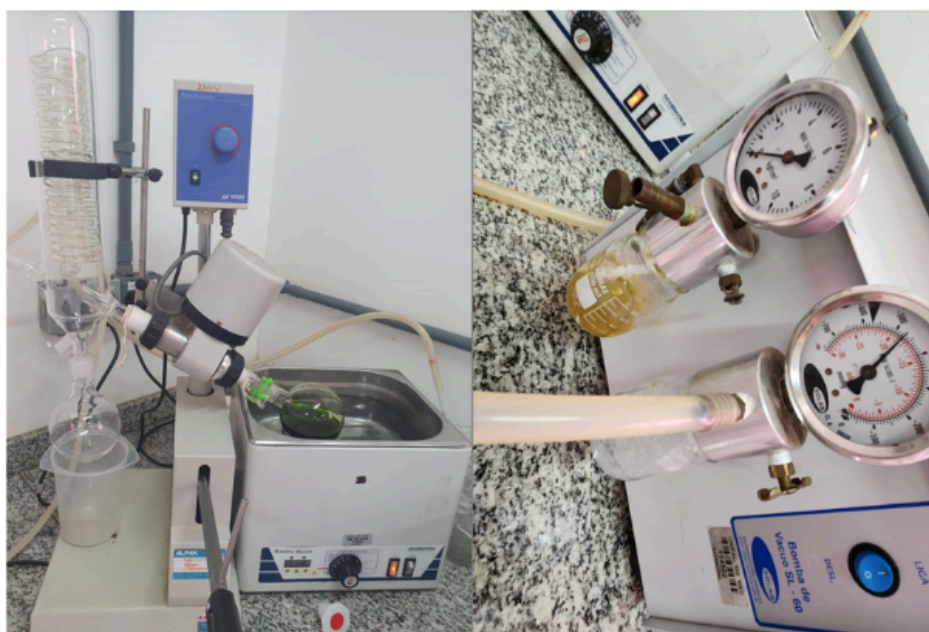
Fotografia 7 — Sistema de rotaevaporação Fonte: Próprio autor
