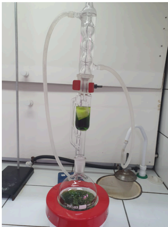
Fotografia 8 — Montagem utilizada para extração Soxhlet
