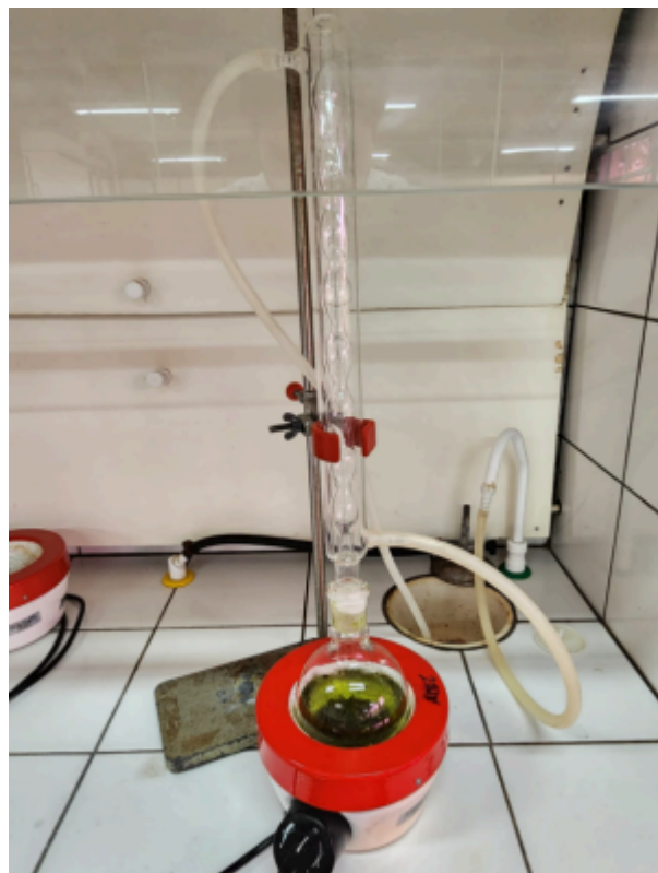
Fotografia 10 — Montagem utilizada para decocção
