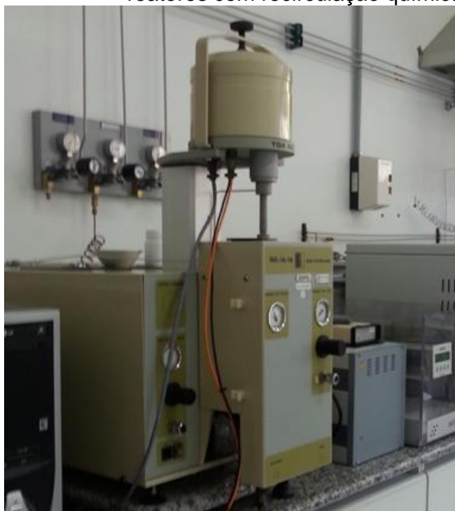
Figura 12 - Termobalança utilizada na avaliação dos materiais para potencial aplicação em reatores com recirculação química.
