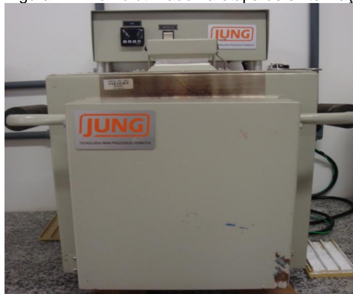
Figura 11 - Forno utilizado na etapa de sinterização.
