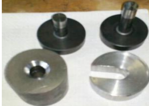
Figura 10 - Matriz utilizada na conformação dos pós cerâmicos.
