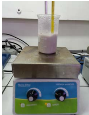
Figura 12 - Sistema montado para a reação de dissolução do ferro contido na mistura de pós. Fonte: Próprio autor.
