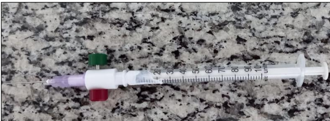
Figura 9 - Conjunto utilizado para injeção de metano no cromatógrafo
