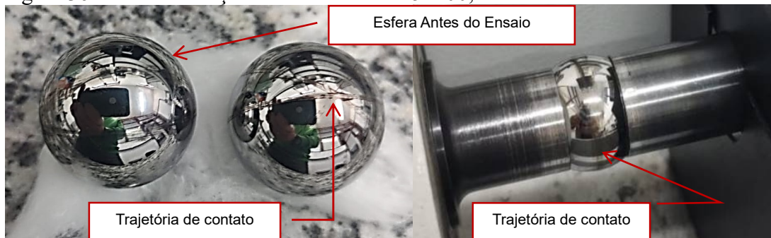
Figura 36 - Esferas de aço martensítico AISI 52100, antes e durante o ensaio
