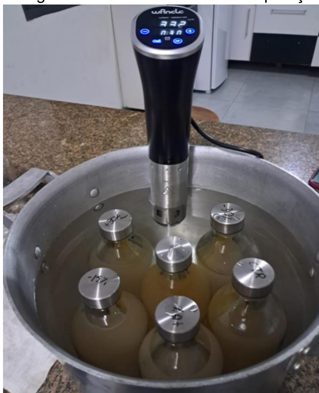
Fotografia 3 – Termocirculador em operação
