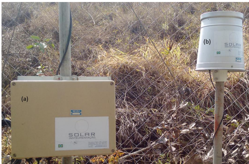
Figura 12 - Estação Hidrossedimentométrica instalada na BHCG – (a) Caixa com circuito interno da estação; (b) Pluviômetro SL 2010. Fonte: Do Autor.
