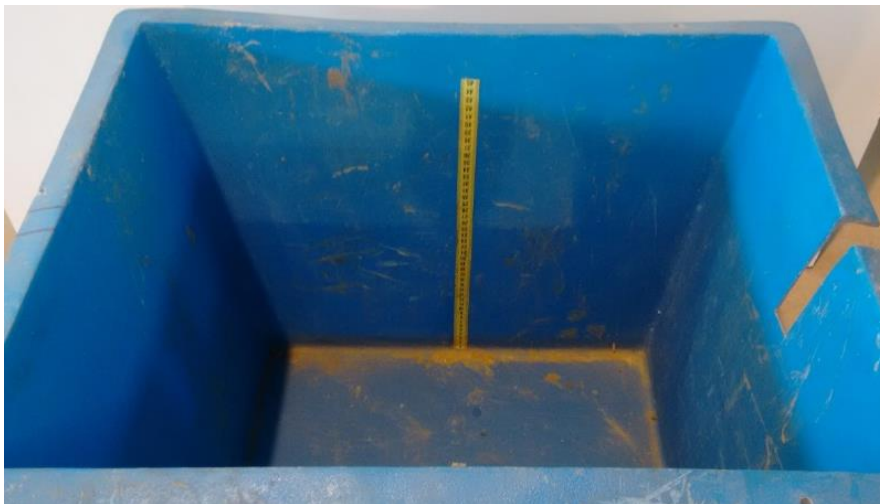
Figura 5 -Caixa com escala métrica (cm) utilizada na calibração e quantificação do deflúvio (Df). Fonte: Do Autor.
