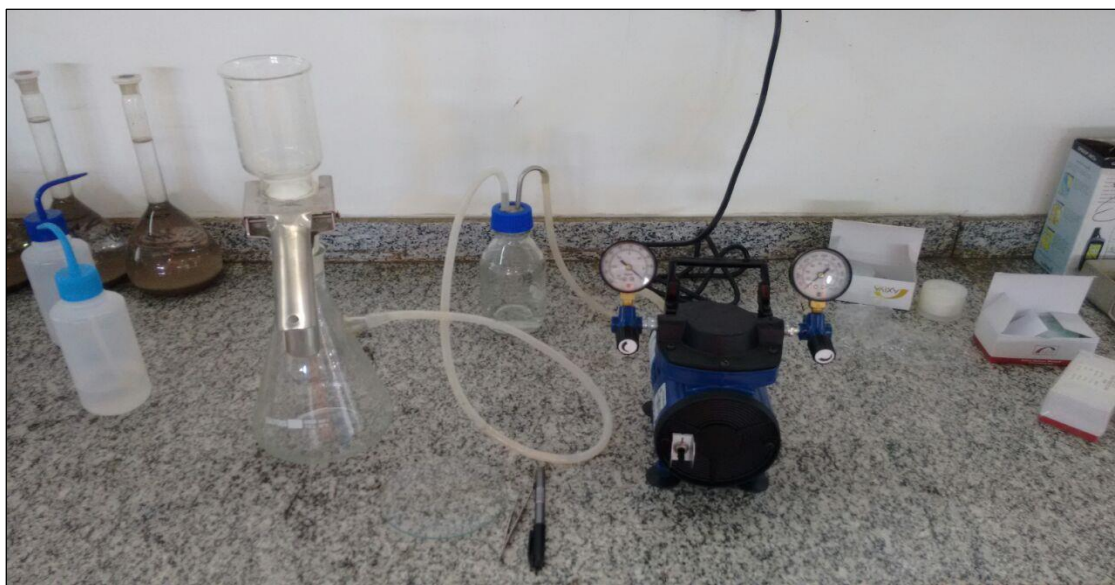
Figura 18 - Aparato de filtração das amostras de hidrossedimento.
