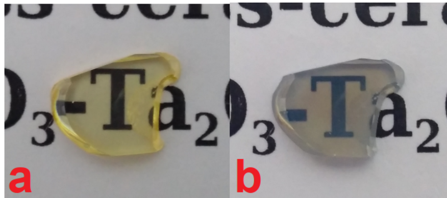
Figura 52 – Vitrocerâmica obtida após a definição dos parâmetros para tratamento térmico.
