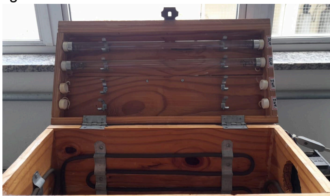
Figura 10 - Reator fotocatalítico utilizado no trabalho
