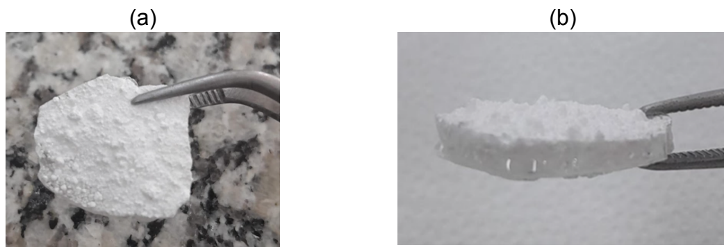
Figura 13 - Compósito obtido por recozimento
