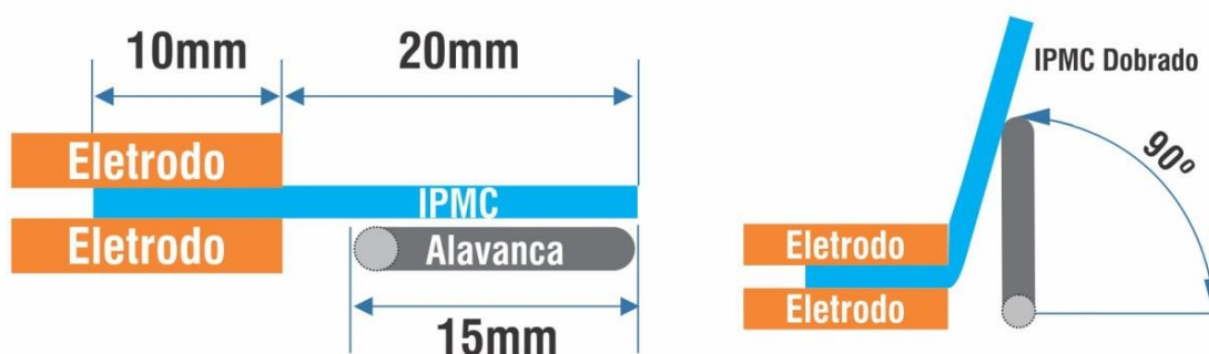
Figura 9 - Configuração da amostra e atuador mecânico
