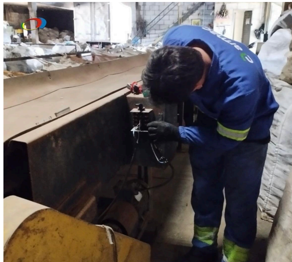
Figura 6 – Manutenção corretiva da esteira de triagem
