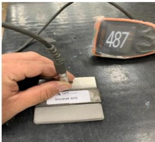
Figura 23- Medição da camada de revestimento
