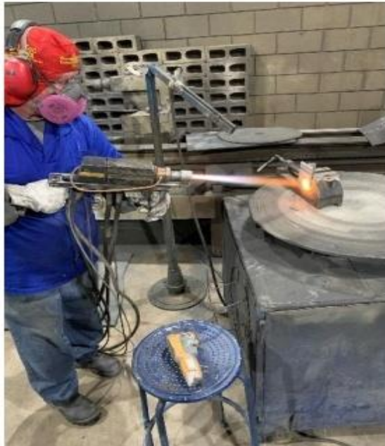
Figura 22- Aplicação do revestimento sobre o substrato de aço carbono 1020
