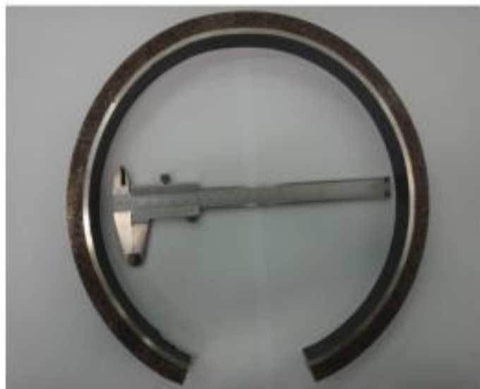
Figura 3- Seção do tubo: parte interna de Inconel 625, parte externa mais escura de aço
