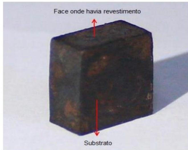
Figura 18- Amostra de carbeto de tungstênio após ciclagem térmica em 900°C
