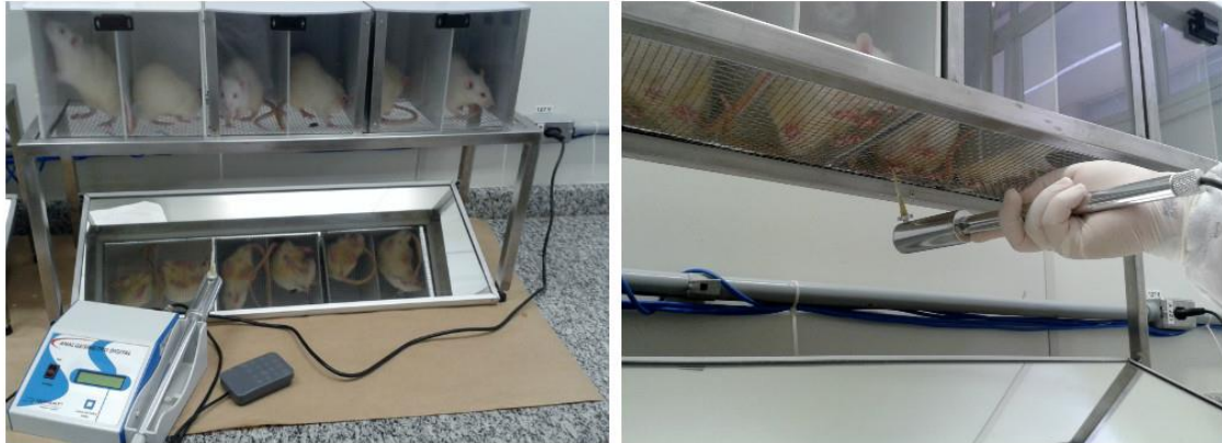
Figura 5 - von Frey eletrônico utilizado para verificar a alodinia mecânica nos ratos de cada grupo experimental. Fonte: Do autor.
