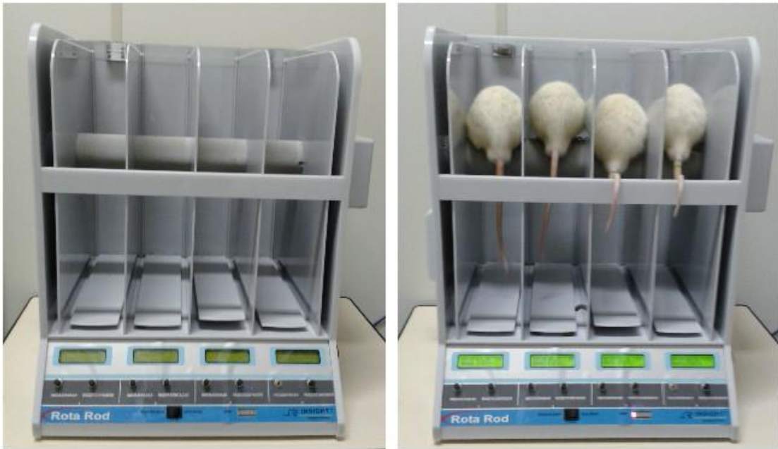
Figura 8B - Rota – Rod utilizado para avaliar o equilíbrio e coordenação motora dos ratos de cada grupo experimental.
