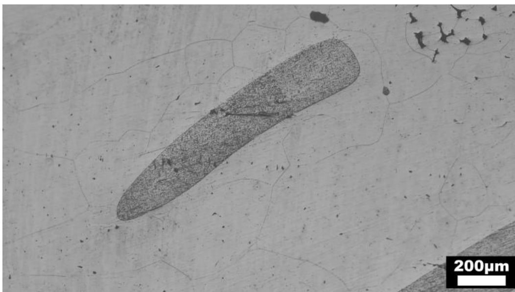
Figura 26 - Micrografia por microscopia óptica da liga 3Nb-3Ti-1Cr-1Al, evidenciando uma região mais escura e morfologicamente distinta da matriz, associada à segregação de Nb
