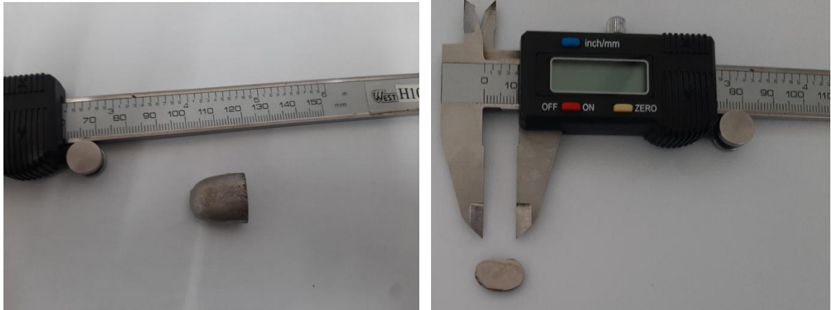
Figura 8 - (a) Lingote da liga 3Nb-3Ti-1Cr-1Al, processado por fundição; (b) Corte do lingote em discos metálicos em forma elíptica com 2 mm de espessura
