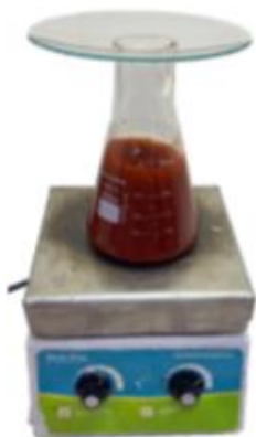
Figura 4 – Extração por Maceração
