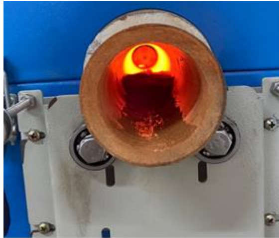
Figura 9 - Forno rotativo visto pela extremidade lateral
