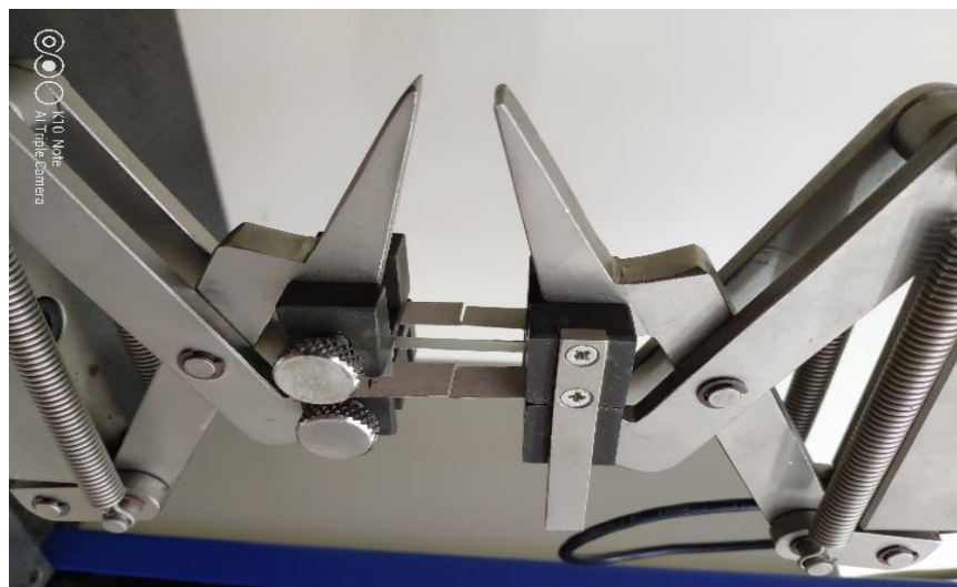
Figura 4 – Detalhe da garra utilizada para fixação dos corpos de prova durante os ensaios de tração.
