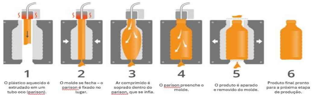
Figura 3: Fluxograma do processo de fabricação de garrafas de PET por injeção e sopro.
