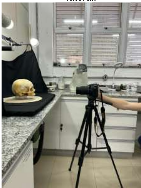
Fotografia 2 – Disposição do sistema fotográfico para a captura de imagens na vista lateral.
