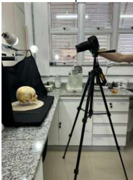
Fotografia 1 – Disposição do sistema fotográfico para a captura de imagens na vista superior.
