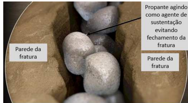
Figura 4 – Ilustração de um exemplo de fraturamento hidráulico com propante
