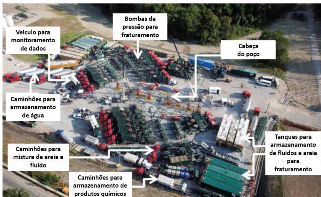
Figura 2 - Imagem de um campo de extração de hidrocarbonetos por meio da técnica de fraturamento hidráulico, realizado no campo “Marcellus” na Pensilvânia, EUA
