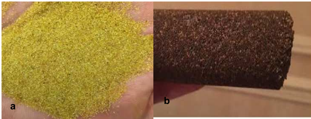
Figura 7 - Imagem de areia revestida com resina antes da aplicação (A) e após condições do processo de fraturamento hidráulico (B)
